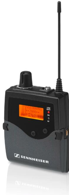
Leichter, robuster Taschensender mit für Bass-Gitarren optimiertem NF-Frequenzgang. Bis zu 6 x 64 frei durchstimmbare Kanäle. Einfache Sender-Empfänger-Synchronisation per Knopfdruck. Ganzmetallgehäuse.
