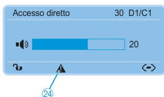
Il sistema avvisa l'utente che si stanno utilizzando hardware diversi o hardware della versione 1 con cablaggio ad anello ridondante (il simbolo «Attenzione» 24 si accende, vedere pagina 103).
