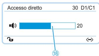
L'unità centrale permette di impostare il volume degli altoparlanti delle console. La visualizzazione standard mostra il volume attualmente impostato <sup>18</sup>.
