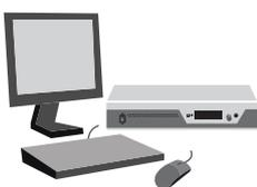
Il software è preinstallato sull'unità centrale. Per utilizzarlo, collegare monitor, mouse e tastiera direttamente all'unità centrale (vedere «Preparazione all'utilizzo del software integrato nell'unità centrale» a pagina 126).
