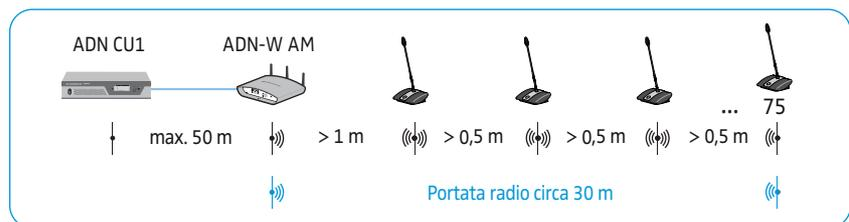
La portata radio del modulo antenne e delle console wireless è di circa 30 m; essa può variare in base all'ambiente o alla qualità della sala.
