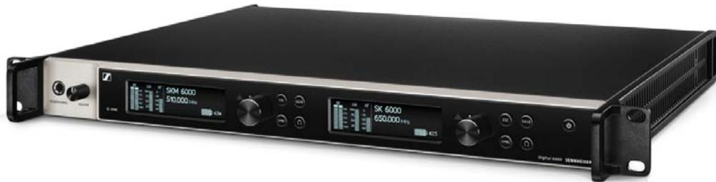
El receptor digital de dos canales funciona con un ancho de banda de conmutación de 244 MHz (470–714 MHz), cubierto por tres modelos de transmisores. En el caso de instalaciones mayores de múltiples canales es posible conectar hasta ocho EM 6000 en cascada sin divisores de antena adicionales y solo con un par de antenas.
