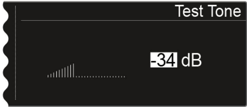
**i** Durante la reproducción del tono de prueba se silencia la señal de audio del transmisor.
