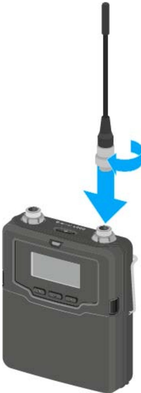
**i** La antena solo se puede insertar en un sentido en la hembra de antena. No introduzca la antena a la fuerza en la hembra de antena del transmisor bodypack.
