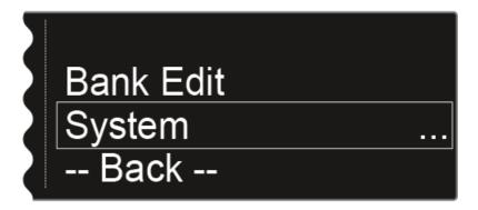
Nel menu di comando sul display del canale CH 1 vengono inoltre visualizzate le impostazioni di sistema per l'intero dispositivo. Vedere "Voce di menu System".
