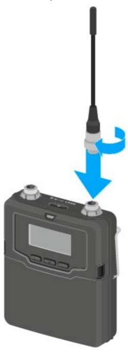
L'antenna può essere inserita molto facilmente nella presa per antenna in un solo orientamento. Inserire l'antenna nella presa per antenna del trasmettitore portatile SK 6000 senza esercitare forze.
