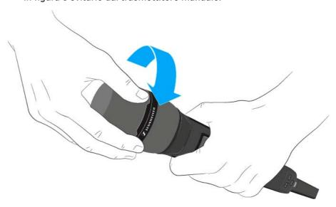
Per alcuni moduli microfoni è possibile avvitare la parte superiore della capsula microfonica. Verificare che il modulo microfono sia sempre completamente svitato.
