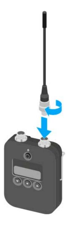
L'antenna può essere inserita molto facilmente nella presa per antenna in un solo orientamento. Inserire l'antenna nella presa per antenna del trasmettitore portatile SK 6000 senza esercitare forze.
