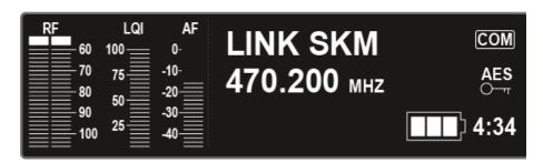
Sui display delle schermate Home per entrambi i canali vengono visualizzate le informazioni di stato specifiche del canale quali la qualità di ricezione, l'autonomia della batteria, il livello audio ecc. Vedere "Schermata Home".
