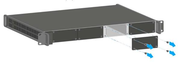
▶ Inserire completamente il modulo di caricamento nel vano di carica aperto come indicato in figura.
