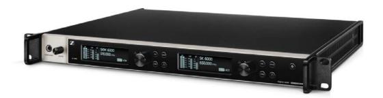
Il ricevitore digitale a due canali lavora su una larghezza di banda operativa di 244 MHz (470 – 714 MHz) coperta da tre versioni di trasmettitore. Per impianti multicanale di dimensioni maggiori è possibile collegare a cascata fino a otto EM 6000 senza l'aggiunta di uno splitter d'antenna risultando quindi necessaria una sola coppia di antenne.
