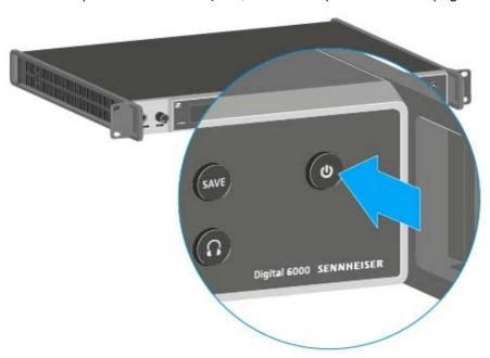
Non appena il ricevitore EM 6000 è stato collegato alla rete, il tasto **On/Off** si illumina oscurato. Se nel menu è attivata la tensione booster per antenne, questa è già attiva prima dell'accensione del ricevitore EM 6000.
