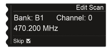
▶ Ruotare il jog dial per selezionare un ulteriore canale da tralasciare.
