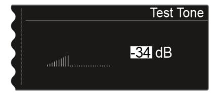
Durante la riproduzione del Test Tone, il segnale audio del trasmettitore viene silenziato.
