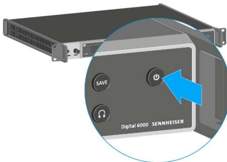
**i** Sobald der EM 6000 mit dem Stromnetz verbunden wurde, leuchtet die Taste **On/Off** gedimmt. Ist im Menü die Booster-Spannung für Antennen aktiviert, ist diese bereits vor dem Einschalten des EM 6000 aktiv.
