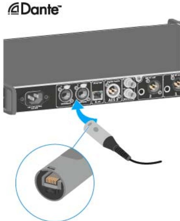
Wir empfehlen, einen Ethernet Connector wie in der Abbildung dargestellt zu verwenden.
