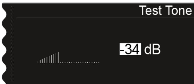
**i** Während der Wiedergabe des Testtons wird das Audiosignal des Senders stummgeschaltet.
