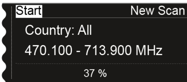
Nach erfolgtem Scan wird das Ergebnis angezeigt. Es werden alle freien Frequenzen in dem ausgewählten Bereich angezeigt.
