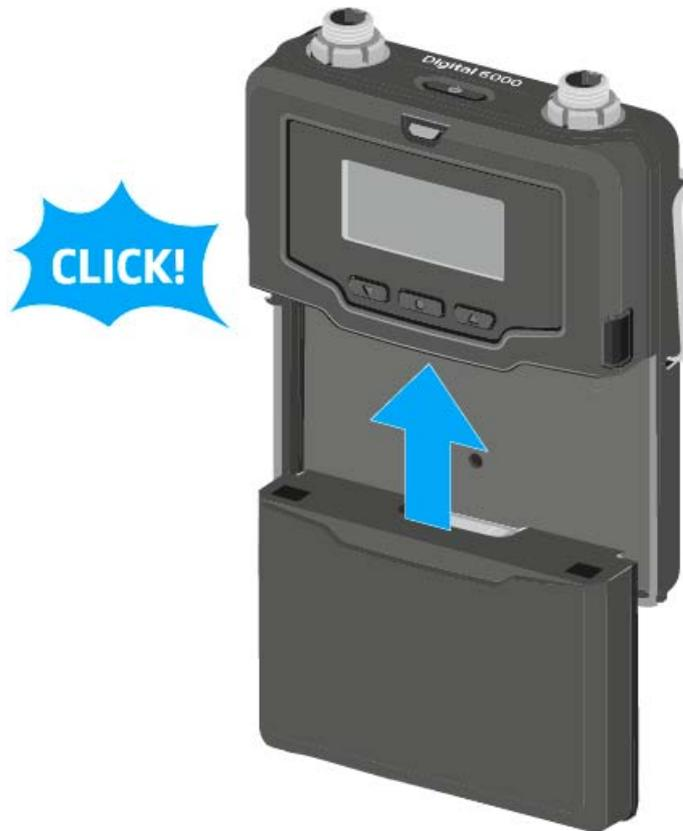
Um das Batteriefach B 61 aus dem Taschensender SK 6000 zu entnehmen:
