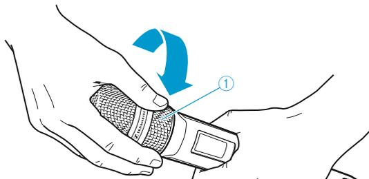
**i** Cuando se desenrosca el módulo de micrófono ① durante el funcionamiento, el modo silencio se activa automáticamente.
