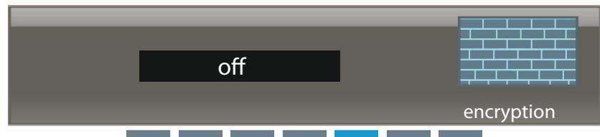
En la opción de menú «Encryption» puede proteger la señal de audio contra la escucha por parte de otros receptores vinculando el transmisor al receptor EM 9046. Otros receptores pueden recibir la señal de radiofrecuencia de estos transmisores, pero no pueden evaluar su señal de audio.
