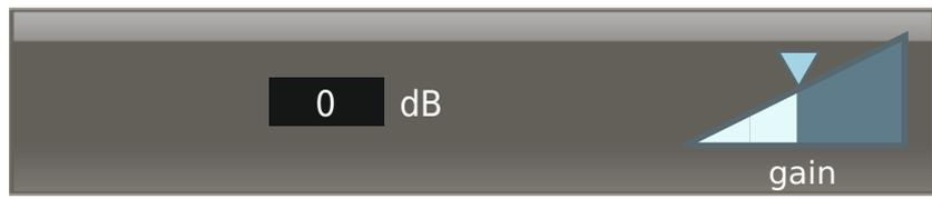
Alla voce di menu «Gain» è possibile impostare l’amplificazione d’ingresso dei canali selezionati a condizione che il trasmettitore da sincronizzare supporti il valore impostato. Il valore preimpostato è pari a -6 dB. Il campo di valori varia da -6 dB a +60 dB.
