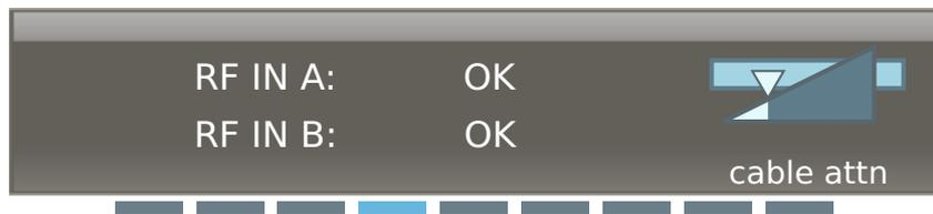
Il ricevitore EM 9046 misura l'attenuazione del cavo tra i booster delle antenne e gli ingressi delle antenne (15) e (16) e la compensa automaticamente nelle situazioni seguenti:
