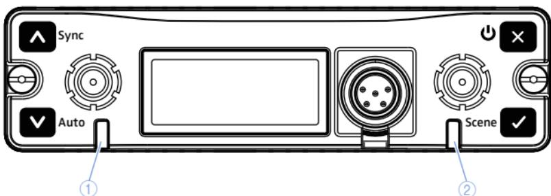
① Lysdiode CH1 Statuslysdiode til modtagelseskanal CH1
