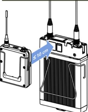
Frekvensen, der er indstillet på EK 6042, overføres til senderen. Hvis denne overførsel lykkedes, lyser statuslysdioderne på den tilsvarende modtagelseskanal grønt, hvis lyden på senderen ikke er frakoblet.
