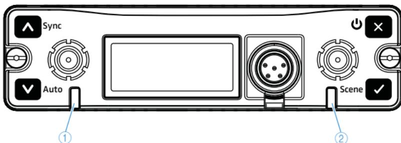
① LED CH1 status-LED voor ontvangstkanaal CH1
