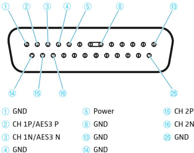
Unbelegte Pins dürfen nicht mit einem Signal belegt werden.
