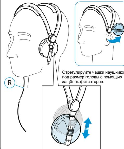
Отрегулируйте чашки наушников под размер головы с помощью защёлки-фиксаторов.
