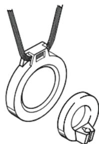
Con il supporto magnetico MZM 10 e MZM2 il microfono aderisce in modo invisibile ai vestiti. Spesso la forza d'attrito della stoffa è sufficiente per evitare spostamenti dello stesso. In caso di tessuti lisci si utilizza come supporto aggiuntivo la corda da indossare come una collana.
