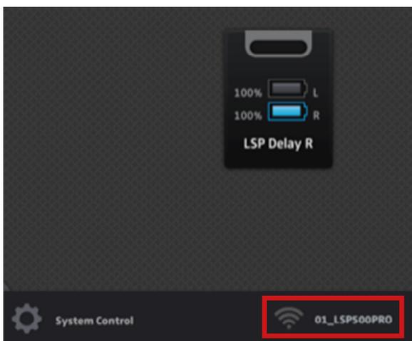
In der LSP 500 PRO iPad App ist die SSID des aktuellen Wi-Fi Netzwerks in der Tab-Leiste sichtbar. So kann leicht überprüft werden, ob man sich immer noch im gewählten Wi-Fi Netzwerk befindet, nachdem man dessen Reichweite verlassen hat und zurückkehrt.
