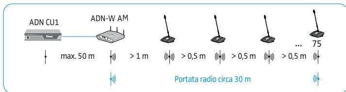
La portata radio del modulo antenne e delle console wireless è di circa 30 m; essa può variare in base all'ambiente o alla qualità della sala.
