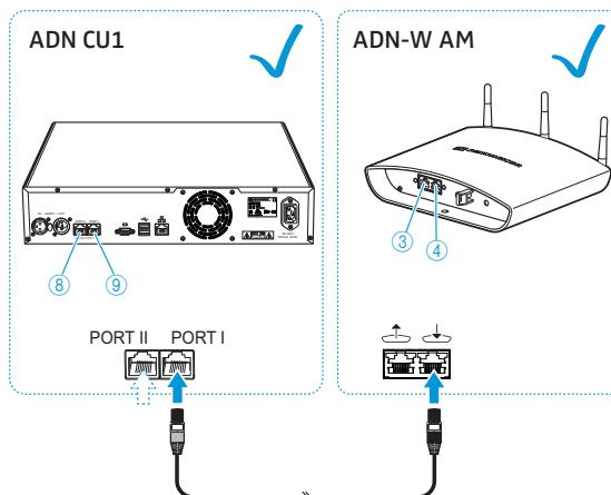
Se si combina il modulo antenne opzionale con console cablate, cablare il modulo antenne come una console cablata:
