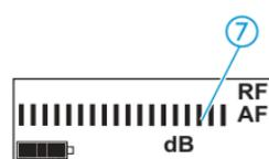
Die Empfindlichkeit ist richtig eingestellt, wenn nur bei den lautesten Passagen die Aussteuerungsanzeige des Audio-Pegels (AF) Vollausschlag ⑦ anzeigt oder die rote LED ② hell leuchtet. Sie können die Empfindlichkeit in 1-dB-Schritten im Bereich von +40 dB bis -30 dB verändern.
