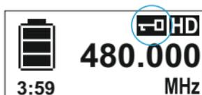
**SK 9000 einschalten und eingestellte Frequenz prüfen, bevor das Funksignal aktiviert wird**
