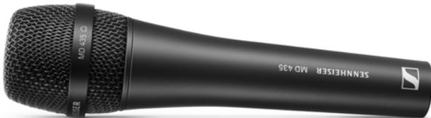
Dynamisches Gesangsmikrofon mit nuancierter Auflösung und Transparenz für detailreichen Klang. Das High-End-Modell MD 435 setzt Vocals auch in lauten Live-Umgebungen klar und souverän durch. Die federnd gelagerte Kapsel, robuste Bauweise und eine Brummkompensationsspule schirmen äußere Einflüsse zuverlässig ab.
