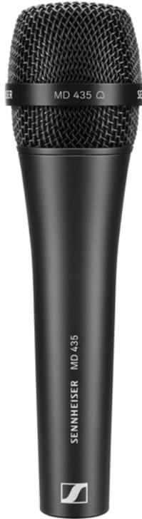
Micrófono dinámico para vocales con resolución matizada y transparencia para un sonido detallado. El modelo de alta gama MD 435 reproduce vocales con claridad y confianza, incluso en entornos ruidosos. La cápsula montada con resortes, su diseño resistente y la bobina con compensación de zumbido brindan protección contra influencias externas.
