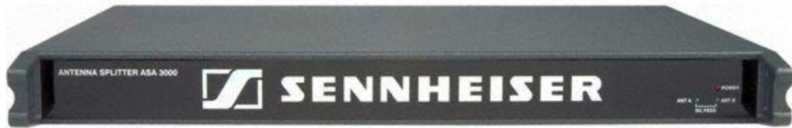
Der ASA 3000 ist ein aktiver Antennensplitter 2 x 1:8 zum Aufbau von Mehrkanalanlagen mit bis zu 16 Kanälen. Mit seinen Breitband-Eingangsmodulen ist er universell im gesamten UHF-Frequenzbereich einsetzbar. Alternativ kann der Frequenzbereich durch wechselbare selektive Eingangsmodule eingeeengt werden.
