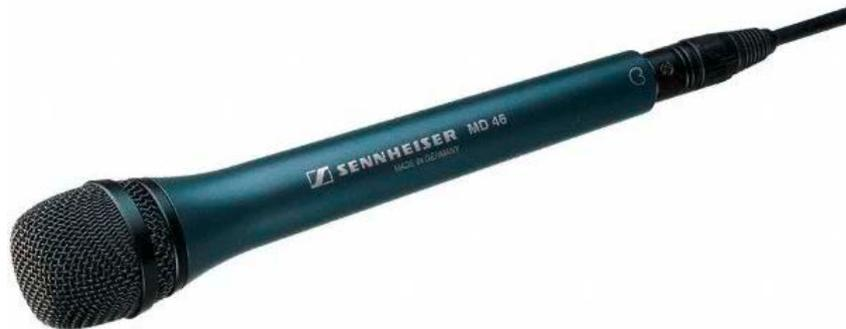
Das MD 46 ist ein hochwertiges dynamisches Mikrofon mit Nierencharakteristik. Entwickelt wurde es für den rauen Routineeinsatz bei Reportagen für Funk und Fernsehen. Das MD 46 ist einfach zu handhaben, denn der spezielle Aufbau vermeidet Probleme mit Wind- und Körperschall.
