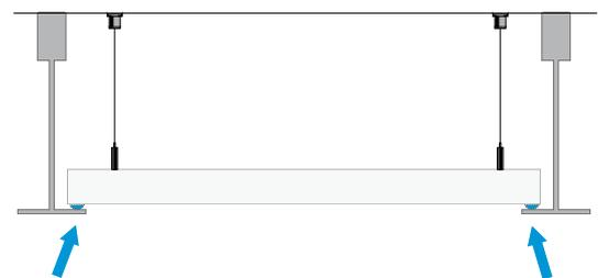
Installer le TeamConnect Ceiling 2 sans équerre de montage dans le plafond (dimensions modulaires 600 x 600 mm)
