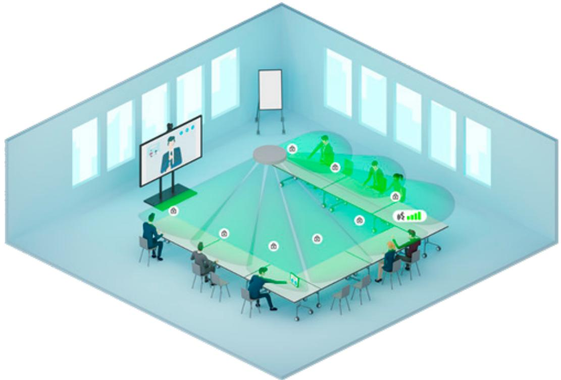
*Deckenmikrofon mit mehreren Beamforming-Zonen*
