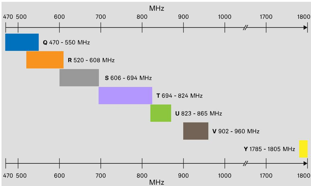
Der Antennen-Splitter **EW-D ASA** ist in den folgenden Frequenzbereichen erhältlich:
