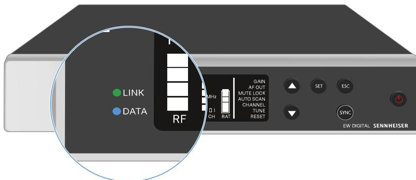
Die beiden LEDs **LINK** und **DATA** auf der Vorderseite des Empfängers können die folgenden Informationen anzeigen.
