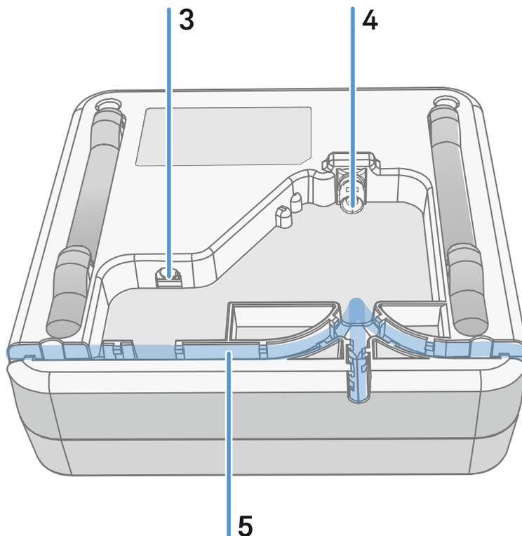
3 Anschlussbuchse **DC in** für das Steckernetzteil
