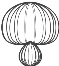
Principalement utilisé avec les microphones à col-de-cygne, car seuls des réglages de volume moins conséquents sont nécessaires, ce qui permet une plus grande liberté de mouvement vers/depuis le microphone. Comparés à d'autres microphones, les micros Supercardioïdes permettent une plus grande distance entre le haut-parleur et le micro lui-même
