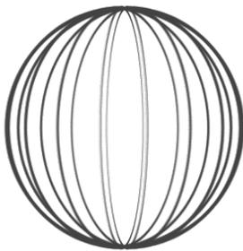
En général, la meilleure façon de capter le son. La position du microphone n'a pratiquement aucun effet sur la captation du son. En raison de la possibilité de création de Larsen, il n'est pas recommandé d'utiliser des microphones Omnidirectionnels dans un environnement sensible avec beaucoup de réflexion acoustique – dans des pièces avec des installations de haut-parleurs, parois en verre, etc.
