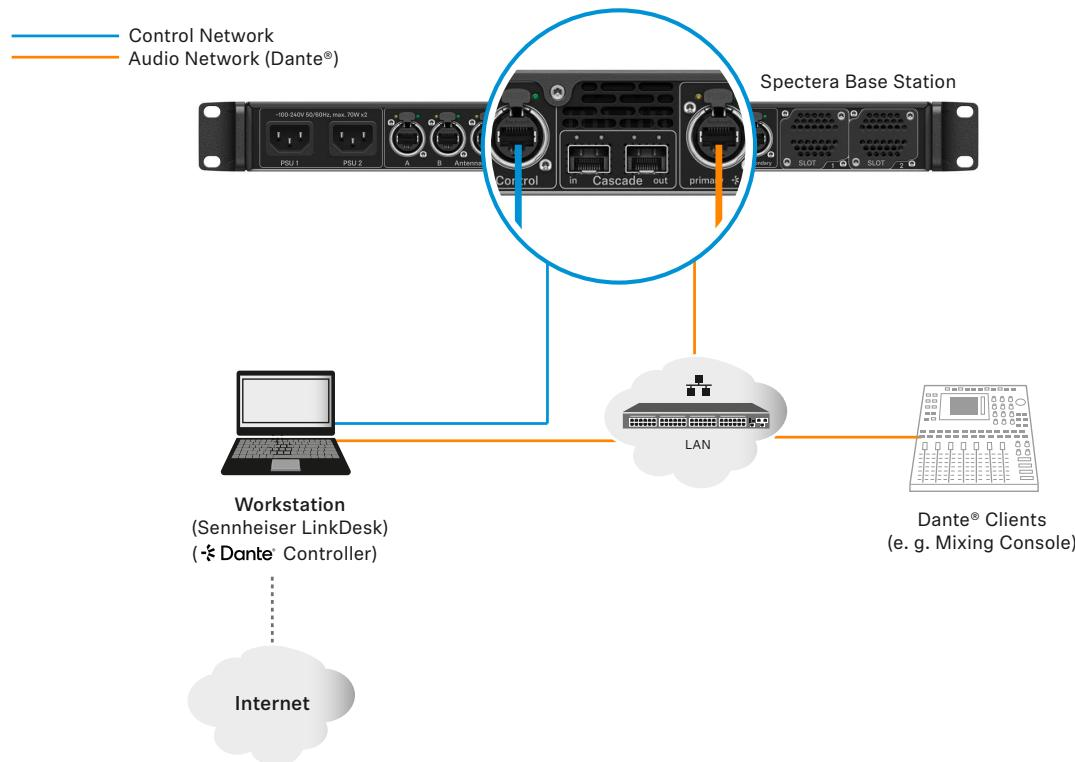
在此设置中，单个工作站将用于所有客户端软件应用程序(Sennheiser LinkDesk、Spectra WebUI及Dante®控制器)。可采用两个独立有线网络接口分别传输控制信号与音频(Dante®)，亦可共享单一接口。请注意此类设置(通常)不激活DHCP服务。请选择手动IP设置或ZeroConf配置。
