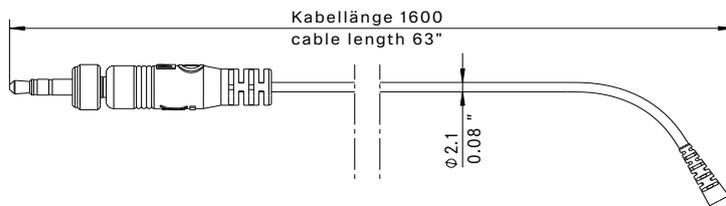
Kabel mit 3-poligem Spezialstecker / cable with 3-pin special connector
