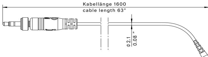
Kabel mit 3-poligem Spezialstecker / cable with 3-pin special connector
