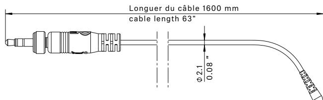
Câble de raccordement avec connecteur spécial à 3 broches
