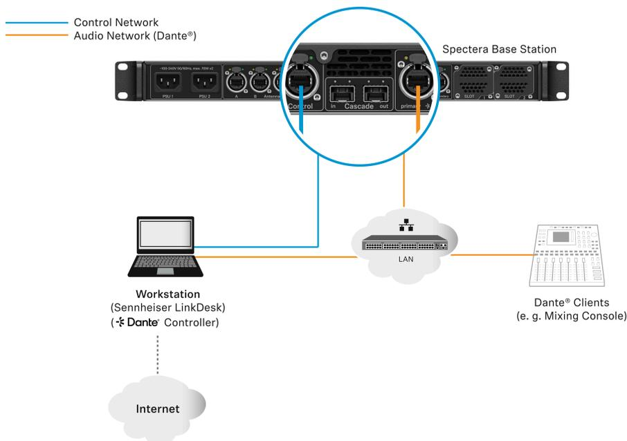
Dentro de esta configuración, se utiliza una estación de trabajo para todas las aplicaciones de software cliente (LinkDesk de Sennheiser, Spectera WebUI, Dante® Controller). Se utilizan dos interfaces de red cableadas separadas para control y audio (Dante®) o se comparte una interfaz. Tenga en cuenta que en estas configuraciones (normalmente) no se activa ningún servicio DHCP. Utilice la configuración manual de IP o la configuración de ZeroConf.
